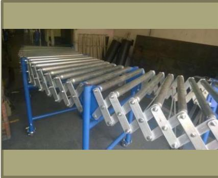
**Objetivo:** que el alumno utilice sus conocimientos de ingeniería para diseñar y fabricar una banda transportadora expandible.
