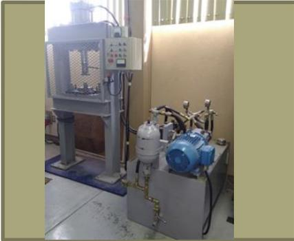
**Objetivo:** que el alumno utilice sus conocimientos de ingeniería para diseñar y construir un sistema hidráulico a velocidad variable y que compare el consumo de energía con un sistema de velocidad fija..
