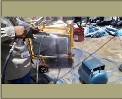
**Objetivo:** que el alumno utilice sus conocimientos de ingeniería para diseñar y fabricar una máquina o sistema que sirva para realizar la limpieza de partes con agua, utilizando el método de sand blast.
