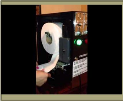
**Objetivo:** que el alumno utilice sus conocimientos de ingeniería para diseñar y fabricar un dispositivo que sirva para recuperar rollos de papel para el baño y para las manos que hayan quedado reducidos para formar rollos completos.
