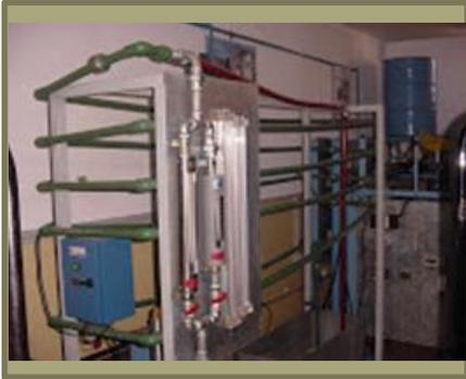
**Objetivo:** que el alumno utilice sus conocimientos de ingeniería para diseñar y fabricar un banco de pruebas para realizar las prácticas concernientes a la medición de parámetros (nivel, presión, caudal, etc.) a través de la configuración y parametrización de los diversos sensores industriales existentes.
