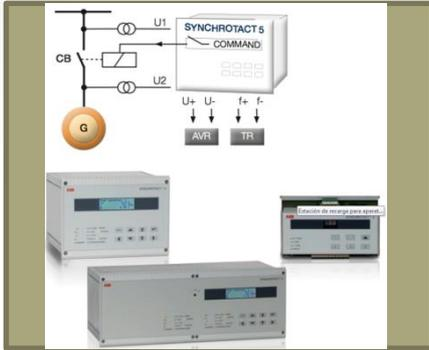
**Objetivo:** que el alumno utilice sus conocimientos de ingeniería para diseñar y construir un sincronizador automático de generadores síncronos. El sincronizador automático debe estar basado en microprocesador e incluir funciones de llevar un generador a la línea en mínimo tiempo.
