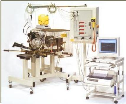
**Objetivo:** que el alumno utilice sus conocimientos de ingeniería para diseñar y construir un sistema de adquisición de datos para banco de pruebas de motores de combustión interna existente.
