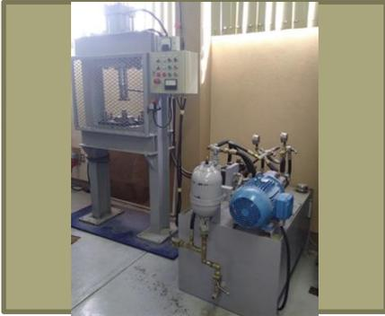
**Objetivo:** que el alumno utilice sus conocimientos de ingeniería para diseñar y fabricar un banco de pruebas para comparar esquemas de ahorro de energía en sistemas hidráulicos de potencia.
