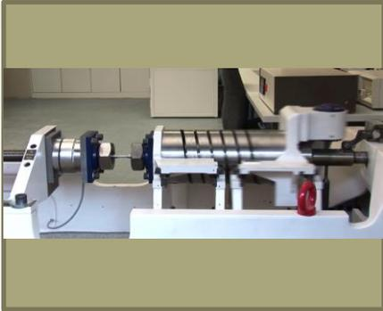
**Objetivo:** que el alumno utilice sus conocimientos de ingeniería para diseñar y fabricar un dispositivo para realizar pruebas de fatiga por medio de cargas axiales.
