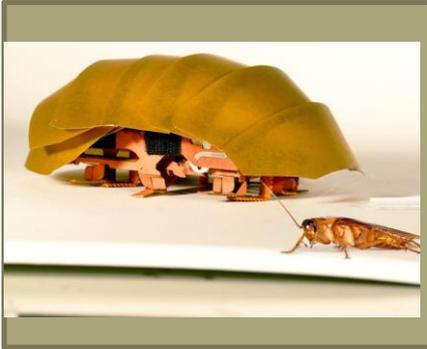
**Objetivo:** que el alumno utilice sus conocimientos de ingeniería para diseñar y fabricar un robot a escala que sirva para imitar el aplastamiento que una cucaracha es capaz de soportar sin sufrir ningún daño.
