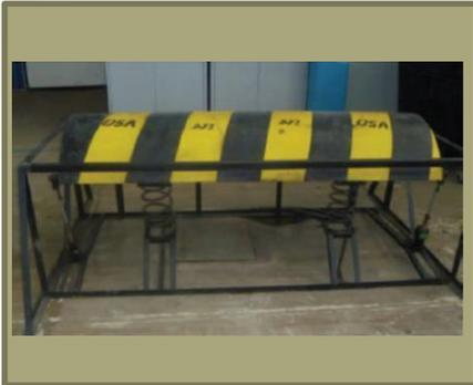
**Objetivo:** que el alumno utilice sus conocimientos de ingeniería para diseñar y fabricar un sistema que permita generar energía eléctrica por medio del paso vehicular sobre topes.
