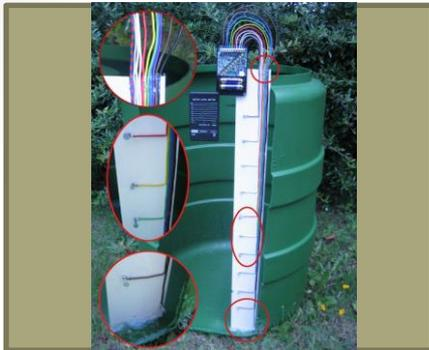
**Objetivo:** que el alumno utilice sus conocimientos de ingeniería para diseñar y fabricar un sistema para censar el nivel de agua en un aljibe.
